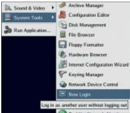
Rysunek 2: Pozycja New Login pozwala przełączać sesje użytkowników bez konieczności przerywania aktywnej sesji i uruchomionych w niej aplikacji.
