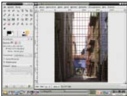
Po umieszczeniu kursora myszy w węzłach na rogach zaznaczenia prostokątnego przystępujemy do korekcji perspektywy poprzez przesuwanie węzłów wzdłuż poziomych krawędzi obrazu. Obszar zaznaczenia przybiera kształt trapezu.
