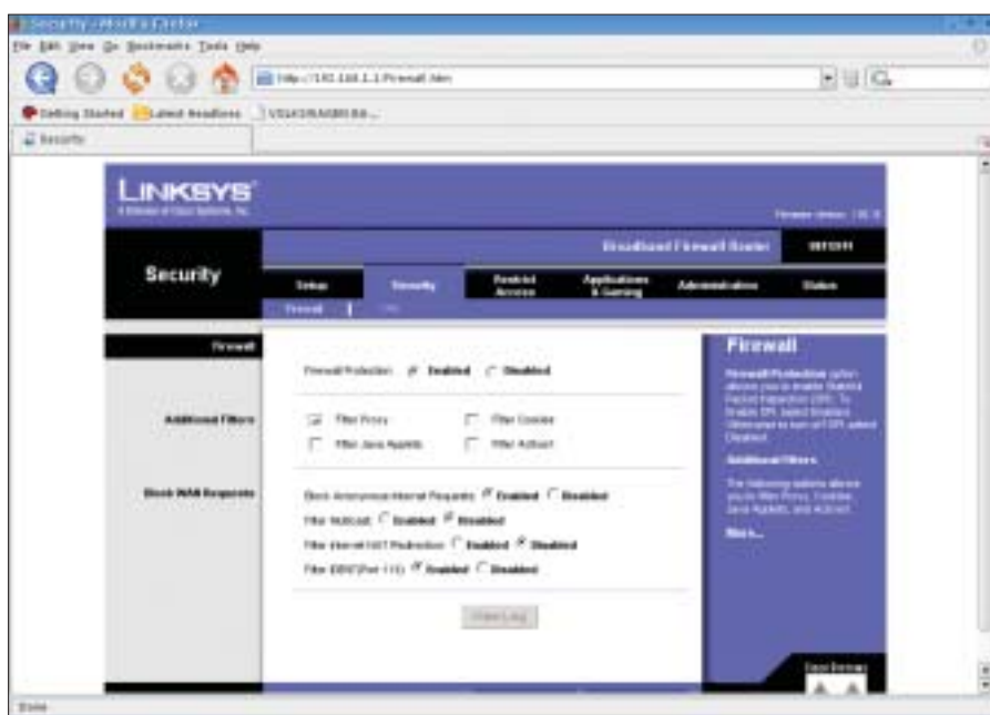
Rysunek 1: Konfiguracja blokowania appletów Java i ActiveX.
