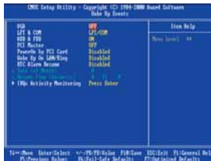
Rysunek 1: Większość systemów BIOS obsługuje funkcję uruchamiania systemu: RTC Alarm Resume lub o podobnej nazwie.
