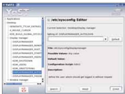
Rysunek 1: Pusty wpis na liście wartości zmiennej „DISPLAYMANAGER_AUTOLOGIN” powoduje wyłączenie automatycznego logowania do systemu.
