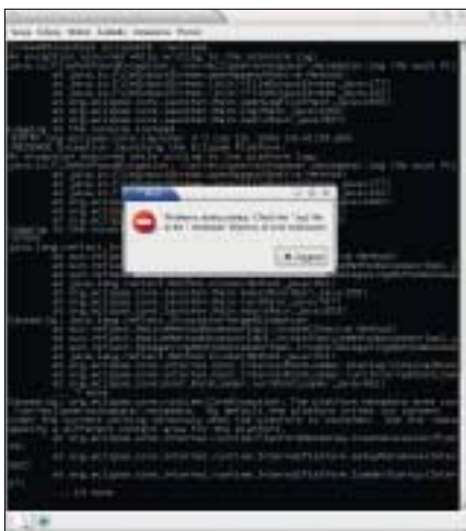
Rysunek 5: Wynik wywołania eclipse przy niewłaściwie skonfigurowanej Javie, np. źle podanej ścieżce do interpretera java.
