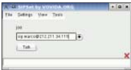
Rysunek 6: GUI SIPset jest proste w obsłudze: wprowadź adres, naciśnij enter, kliknij na przycisk Talk, rozmawiaj.
